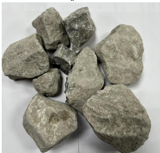
Рис. 1. Внешний вид проб: а – гипсоангидритовый камень (ГАЗ) Заларинского месторождения; б – нейтрализованный фторгипс (НФ)
