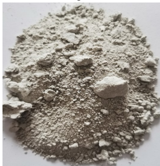
Рис. 1. Внешний вид проб: а – гипсоангидритовый камень (ГАЗ) Заларинского месторождения; б – нейтрализованный фторгипс (НФ)
