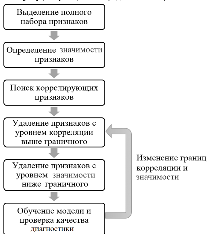
Рис. 2. Алгоритм работы гибридного метода выбора признаков
